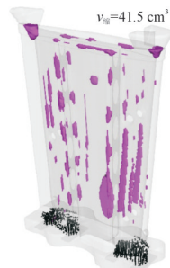
(a) 150 r/min, 25 ℃ 下缩孔缩松缺陷分布图
